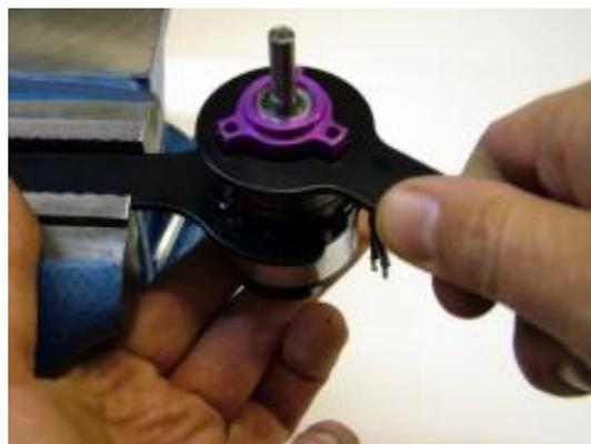
Einführen des Antriebes von unten in den gezahnten Schlüssel, die Motor-Kabel zur offenen Seite weisend. Motor von unten gehalten und mit dem zweiten Schlüssel das Getriebe durch linksdrehen vom Motor lösen.
