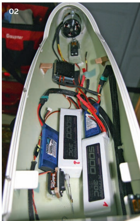
01 | Das AUFWIND-Testmodell für den Umbau auf den neuen Torcman-Antrieb ist ein „Arcus“ (5,33 m, 1:3,75). Foto: Rolf Haselmaier 02 | Der Cockpitbereich des „Arcus“ nach dem Einbau der Antriebseinheit. Motor: NT430-30, 14-polig, 14 Windungen, 2x 4s-LiPo 5.000 mAh. Foto: Rolf Haselmaier
