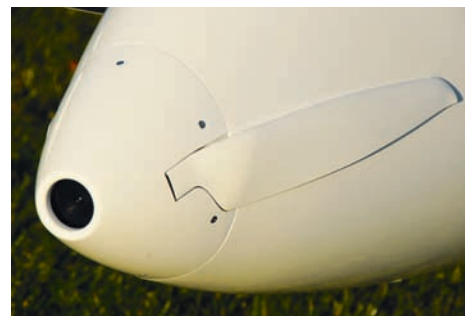
FES-Antrieb im manntragenden „Discus-2c“ von Schempp-Hirth. Foto: Bernd Weber, Schempp-Hirth
