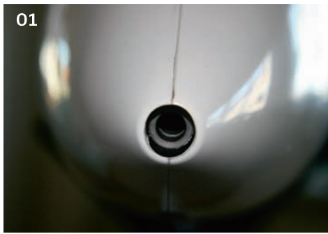
01 | Der „FES-Ex“-Antrieb von Torcman nach dem Einbau in die vorhandene Öffnung für die F-Schlepp-Kupplung. Foto: Rolf Haselmaier 02 | Die Schleppkupplung mit Servo wurde hinter dem Motor neu platziert. Foto: Rolf Haselmaier 03 | Nützliches Zubehör: Die neue Zugleine von Torcman mit Rastbolzen, passend für den „FES-EX“-Antrieb. Mit einem Tragflächenstützrad kann man den Segler zum Start ziehen – auch ohne Schleppkupplung. Foto: Torcman
