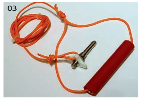
01 | Der „FES-Ex“-Antrieb von Torcman nach dem Einbau in die vorhandene Öffnung für die F-Schlepp-Kupplung. Foto: Rolf Haselmaier 02 | Die Schleppkupplung mit Servo wurde hinter dem Motor neu platziert. Foto: Rolf Haselmaier 03 | Nützliches Zubehör: Die neue Zugleine von Torcman mit Rastbolzen, passend für den „FES-EX“-Antrieb. Mit einem Tragflächenstützrad kann man den Segler zum Start ziehen – auch ohne Schleppkupplung. Foto: Torcman
