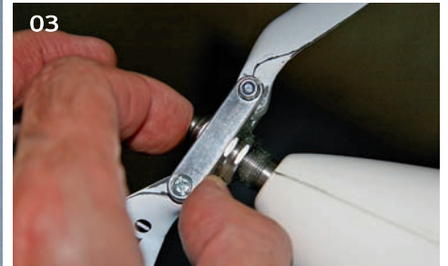
01 | Die einzelnen Komponenten des Torcman-Sets: Außenläufer, Rastwelle, Rastbolzen mit Luftschrauben-Mitnehmer, Lager und Spantensatz. Foto: Torcman 02 | Der vorbildgetreue Akku-Schacht mit Magnetverschluss, Steckplatine und Akkualterung. Foto: modellforum.de 03 | Sicherheit auf Knopfdruck. Der Rastbolzen ermöglicht die einfache Abnahme der Luftschraubenblätter. Foto: Rolf Haselmaier
